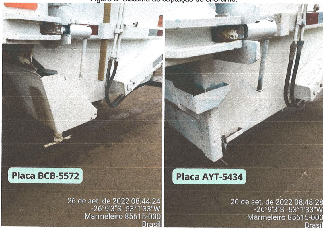
Figura 3: Sistema de captação de chorume.
